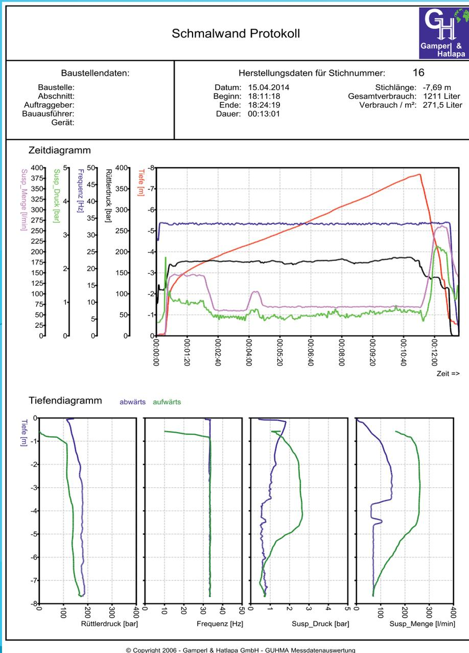
Fertiges Dichtwand protokoll erstellt mit unserer GUHMA Software. In diesem Beispiel, sehen Sie folgende Produktionsdaten: Länge, Drehzahl, Rüttlerdruck, Suspensionsdruck, sowie das tatsächliche Volumen, auf einen Blick. Zudem sehen Sie alle Daten in einem Diagramm über die Zeit sowie einzelne ausgewählte Produktionsdaten in Diagrammen über die Tiefe dargestellt.
